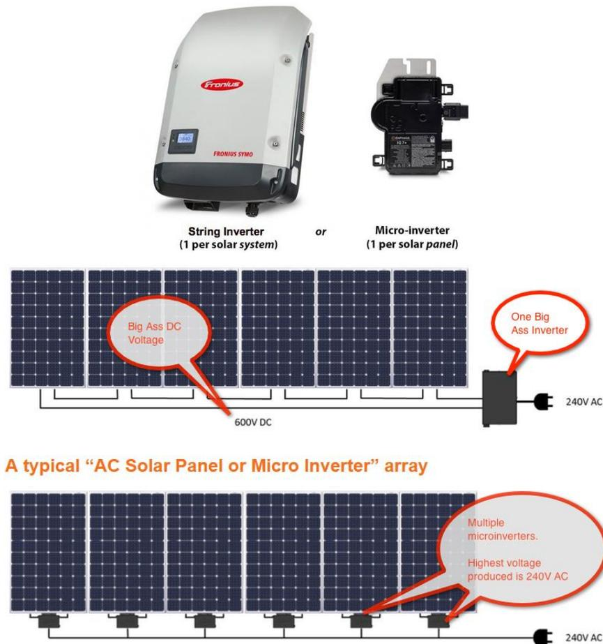
Figure 32: Microinverter<sup>28</sup>
